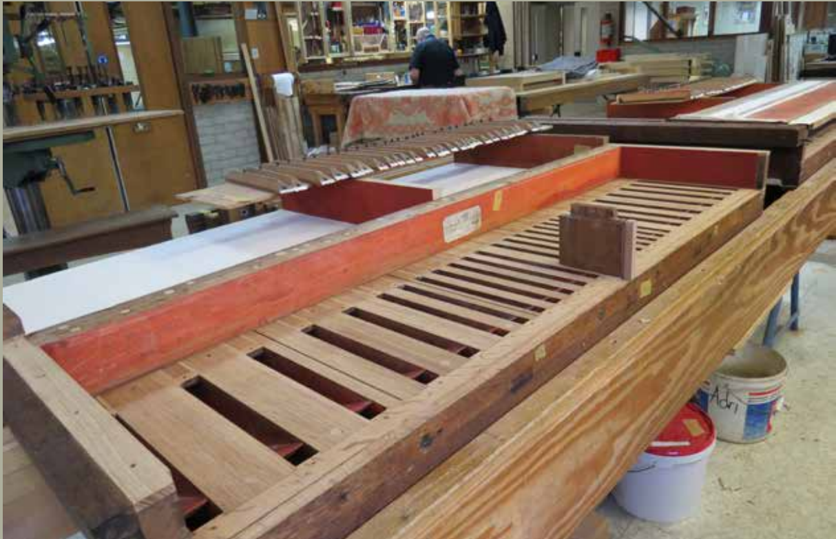
Hier is de onderzijde van de cancellen aan de achterzijde bekleed met leer, voor de winddichtheid. De windlade is hier wat gedraaid t.o.v. de vorige foto, zodat op de achterzijde van de ventielkast een opschrift zichtbaar wordt.
